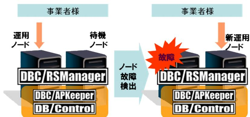
図3 ソリューション「DBC/APKeeper+DB/Control」によるサービス無中断化
